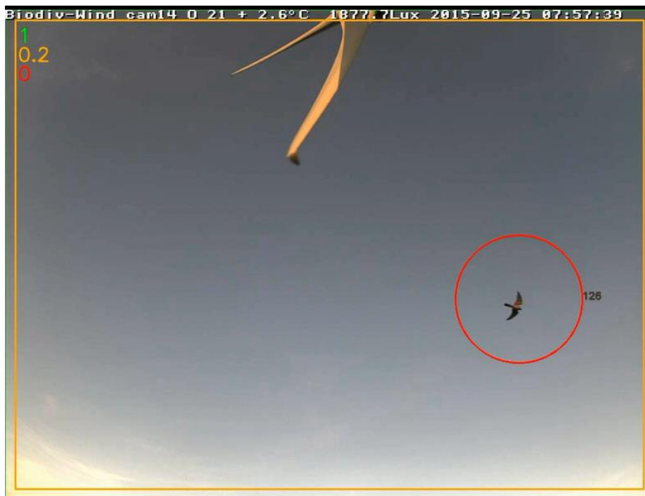
Figure 26 : Illustration du mode de visualisation d'un rapace par le système SAFEWIND
